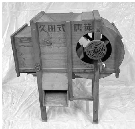
写真4 Cの唐箕 「久田式唐箕」と書かれており金物で出来ている翼車の上部に「合名会社 久田農具製作所」と書かれた銘板が取り付けられている
